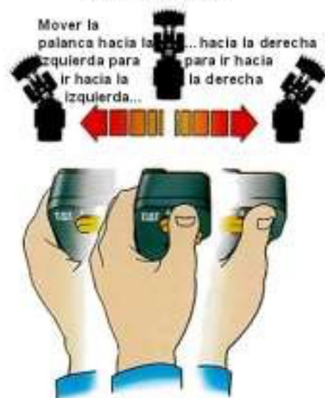
Sistema STIC de control de la dirección
